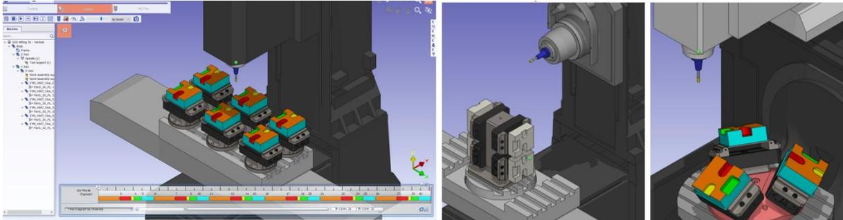
La funzione aggiuntiva "Lavorazione di pezzi multipli" è la soluzione ideale per il bloccaggio multiplo di pezzi più piccoli per la produzione in serie e ottimizza i percorsi utensile per la fresatura su lapidi. Con la versione 6.08 questo add-on è disponibile anche per la lavorazione da 3 a 5 assi.
